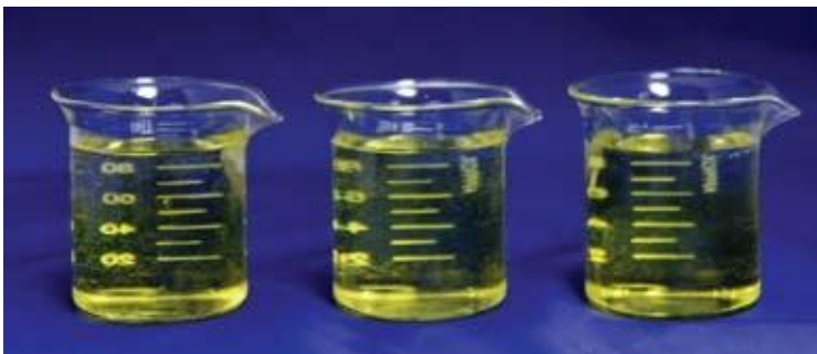
水道水にトルイジンToluidine solution 溶液1mlをそれぞれ入れると、次亜塩素酸と酸化反応を起こして黄褐色に変化する。
